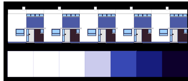
Eingangsansicht der Reihenhäuser Typ F und der dafür vorgesehenen Farbskala
